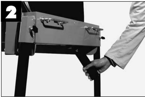
Для правильной эксплуатации станка с режущими дисками Ø 300 необходимо отрегулировать ход режущей головки.
